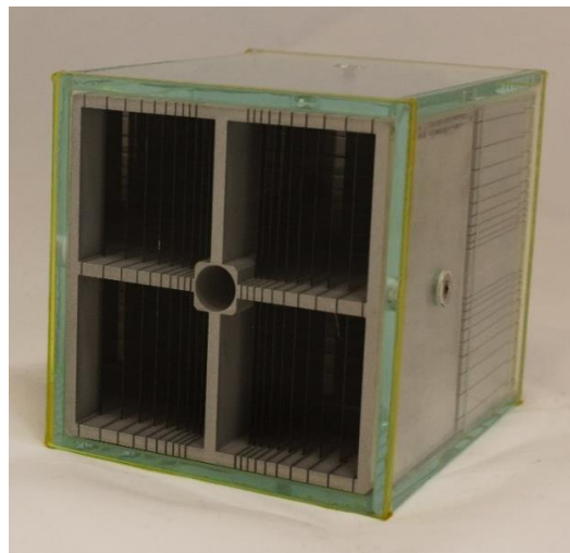
Obr. 2: Fotografie testovací MFO pro širokospektrální rtg. systém. Uprostřed je otvor pro vložení RSO.
