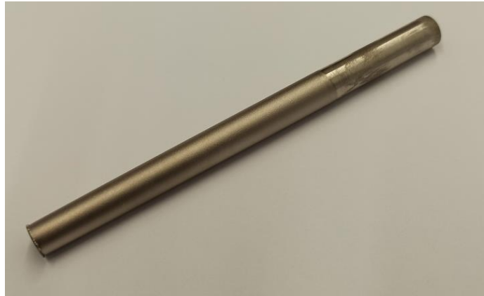
Obr. 1: Fotografie RSO pro širokospektrální rtg. systém – po zabroušení části, která se zasune do MFO.
